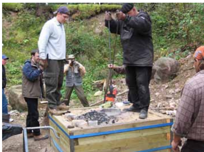
Färdigt abborrforsjärn, luppen tas ut ur ugnen med tång.
