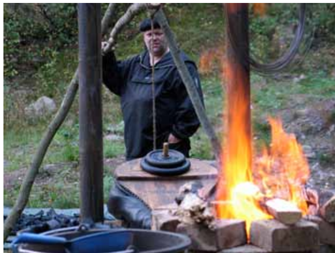
För blåsning behövdes över fem hundra liter luft per minut och blåstringen skedde med en dubbelverkande bälg.
